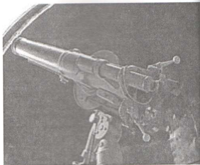
Фото 5. Телескоп АВР-3 с диаметром объектива 130 мм и фокусным расстоянием 1950 мм
