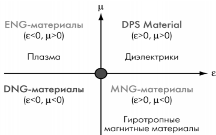
Рис. 1. Классификация физических сред в зависимости от знака величин диэлектрической ( \epsilon ) и магнитной ( \mu ) проницаемостей
