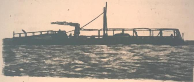
Вооруженіе состоитъ изъ двухъ 14 дюймовыхъ минныхъ аппаратовъ въ носу, одного поворотнаго на палубѣ, позади дымовой трубы и четырехъ пушекъ Готчкисса и Гатлинга.
