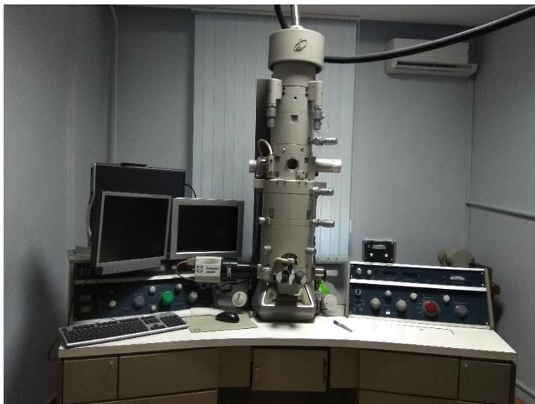
Рисунок 1 – Просвечивающий электронный микроскоп JEOL JEM-100B
