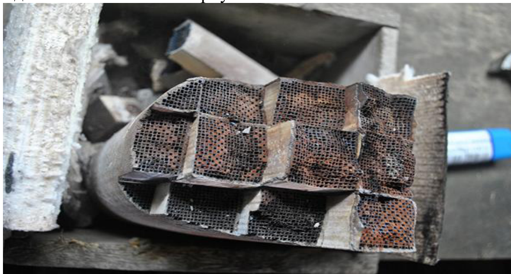
Рис.5 – Внутреннее устройство сажевого фильтра дизельного двигателя
